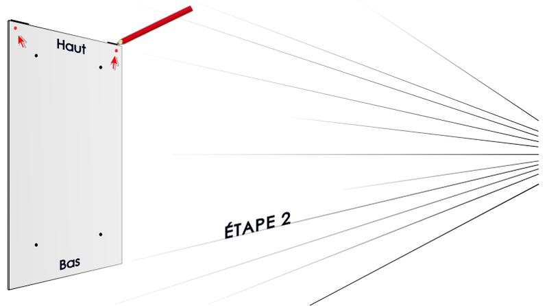
Marquer l'emplacement des trous qui serviront à fixer le gabarit sur le mur avec un crayon à papier voire avec un poinçon.
