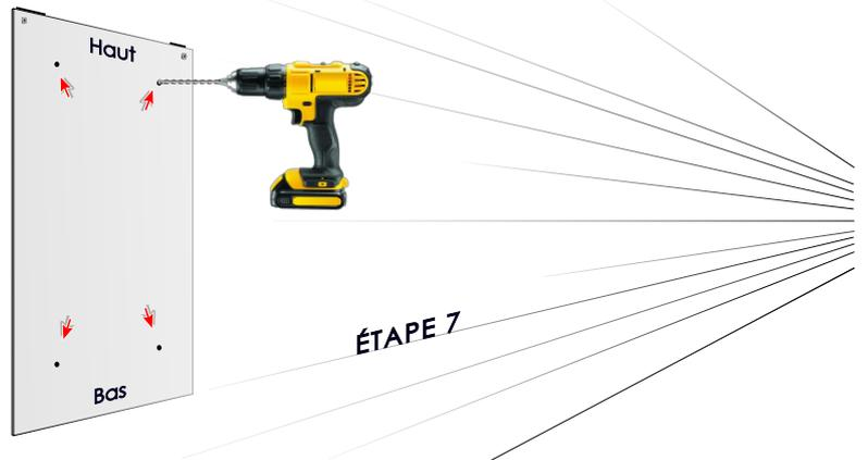
Retirer le gabarit. Percer les 4 trous avec une mèche de 10 mm de diamètre. Profondeur de perçage : 65 mm en tenant la perceuse bien perpendiculaire au mur puis soufflez dans le mur pour retirer les résidus de poussière.
