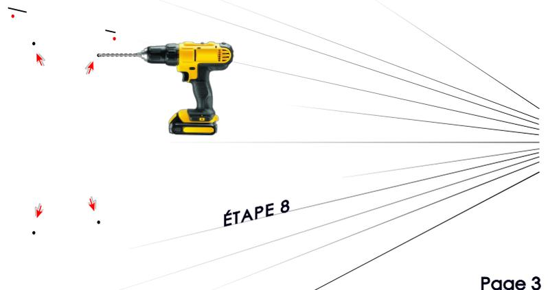
Insérer les 4 chevilles TRIDER/B M6 avec vis tête hexagonale qui sont dans une enveloppe, collée au dos de la plaque, dans chacun des trous.
