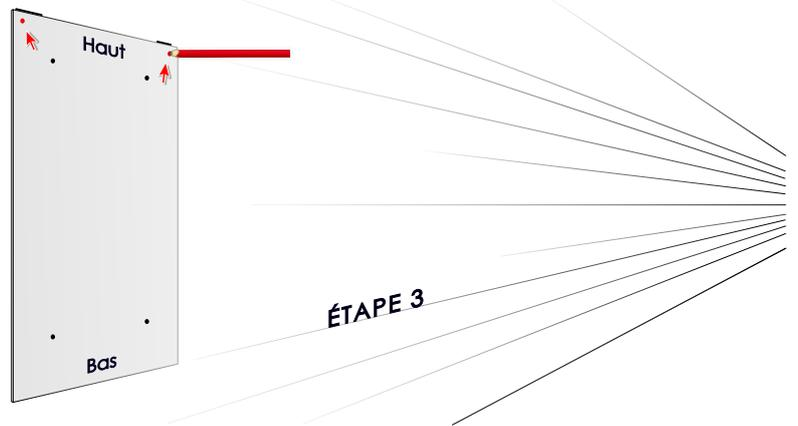
Retirer le gabarit. Percer les deux trous pour fixer le gabarit au mur avec une mèche de 5 mm de diamètre et sur une profondeur de 30 mm en tenant la perceuse bien perpendiculaire au mur.
