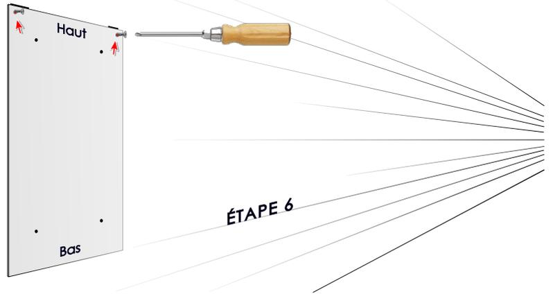
Pré-percer les 4 trous avec une mèche de 5 mm de diamètre en se servant des trous percés sur le gabarit comme de guides. Tenez la mèche de votre perceuse bien perpendiculaire au mur lorsque vous percez.
